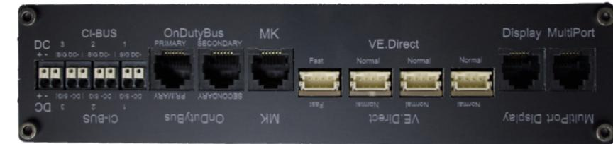
Optional können über die VE.Direct Anschlüsse Geräte des Herstellers VICTRON ENERGY angeschlossen werden, wenn diese über einen VE.Direct Anschluss verfügen. Bei Benutzung eines VICTRON BMV sollte dieser an dem ersten Anschluss von links (FAST) angeschlossen werden um die bestmögliche Haptik zu erhalten.
