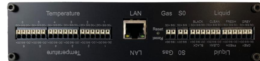
Es können bis zu 6 Temperatur-Sensoren an das System angeschlossen werden. Die Funktion ist nur mit den von uns gelieferten Sensoren gegeben.
