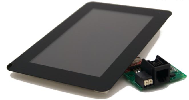
OnDutyDisplay wird über den mitgelieferten Adapter mit OnDutyCore verbunden. Das dazu benötigte RJ12-Kabel ist nicht im Lieferumfang enthalten. Zusätzlich ist die Stromversorgung des Adapters herzustellen (siehe Anschlussdiagramm auf Seite 23).
