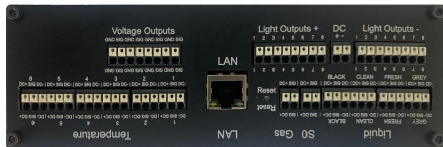
Die maximale Leistung der Ausgänge pro LED-Linie beträgt 10 Watt.
