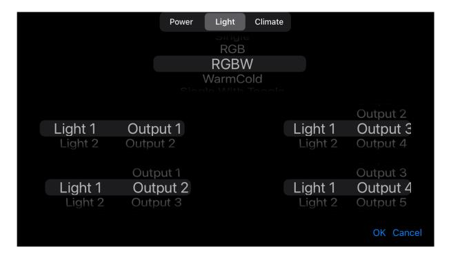
Dies ist ein Beispiel für die Lichtsteuerung eines RGBW-LED-Lichtstreifens. Der R-Kanal wird an Light 1 Output 1 angeschlossen, der G-Kanal an Light 1 Output 2, der B-Kanal an Light 1 Output 3 und der W-Kanal an Light 1 Output 4.
