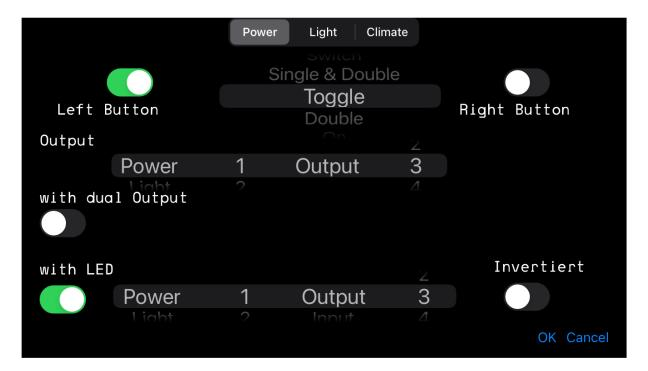
Dies ist ein Beispiel für eine einfache Tastensteuerung mit einer Taste und einer Status-LED, die einen Ausgang ("OnDutyPower 1", Relais 1) umschaltet und den vom selben Ausgang gelesenen LED-Status anzeigt.
