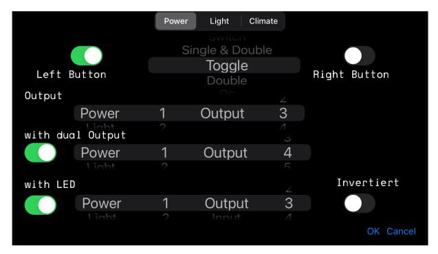
Dies ist ein Beispiel für eine einfache Tastensteuerung mit einer Taste und einer Status-LED, die zwei Ausgänge umschaltet (OnDutyPower 1, Relais 1 und Relais 2) und den vom ersten konfigurierten Ausgang (Relais 1) gelesenen LED-Status anzeigt.
