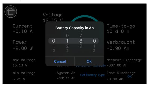
Stellen Sie Ihre Batteriekapazität in Ah ein. Bitte beachten Sie, dass die hier eingestellte Kapazität von der angzeigten Kapazität abweichen kann, da diese aus dem/der Batteriemonitor/Batterie ausgelesen wird.
