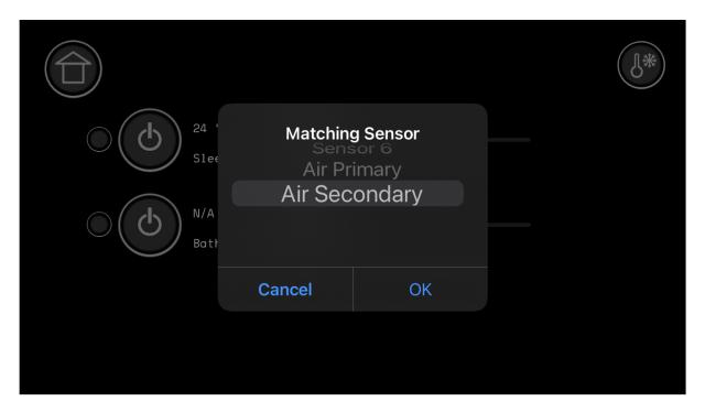
Wählen Sie aus der Liste einen Temperatursensor aus, der nach Klicken auf die Schaltfläche "set sensor" für die Anzeige der Tempertur auf dem Zonenelement verwendet werden soll. Wenn Sie eine "manuelle Heizung"-Regelung verwenden, ist der Sensor für die Regelung fest vorgegeben.
