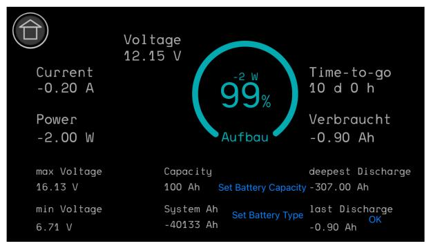
Auf der Batteriedetailseite haben Sie die Möglichkeit, die Batteriekapazität und den Batterietyp einzustellen.
