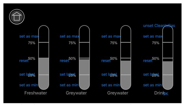
Mit den Schaltflächen "set as max" und "set as min" können Sie den aktuellen Sensorpegel als 0 % oder 100 % einstellen. Die Schaltfläche "reset" löscht diese Sollwerte.
