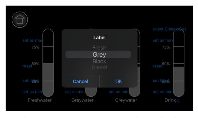
Wählen Sie eine Beschriftung (siehe Anhang B), nachdem Sie auf die Schaltfläche "set label" für jedes Tankelement geklickt haben. Wenn keine Beschriftung konfiguriert ist, wird das Tankelement ausgeblendet.
